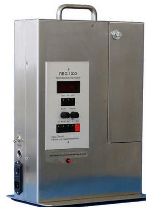
Der RBG 1000 wird zur Fraktionsabscheidegradmessung und zur Beladung mit Stäuben eingesetzt. Durch austauschbare Feststoffbehälter hat der RBG 1000 P einen besonders großen Konzentrationsbereich bei der Dispergierung.
