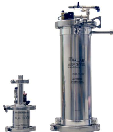
Der AGF 3000 wird zur Beladung der Filter mit Ölaerosolen eingesetzt. Dank seiner speziellen Düse können hohe Massenströme bis 10 g/h erzeugt werden. Dies minimiert die Beladungsdauer. Dieser Generator verfügt über eine automatische Nachfülleinheit für den Ölvorrat.
