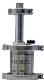
Der PLG 3000 wird zur Fraktionsabscheidegradmessung und zur Beladung mit Ölaerosolen eingesetzt.
